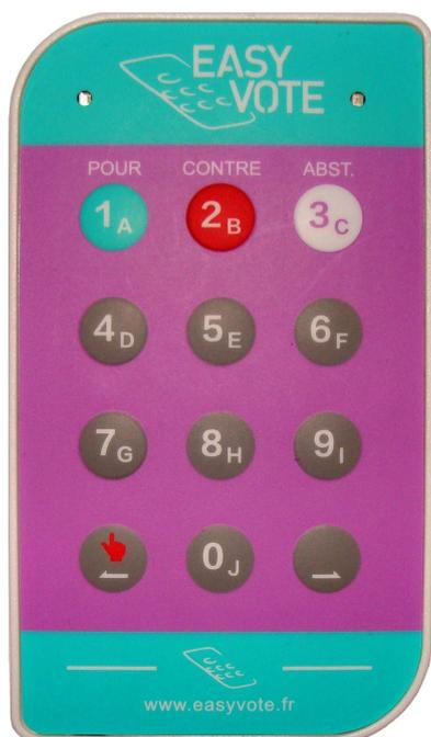
Boîtier de vote électronique avec 12 touches permettant des choix de A à J ou de 1 à 10 (possibilité de ne choisir qu'une seule réponse en fonction du logiciel)
